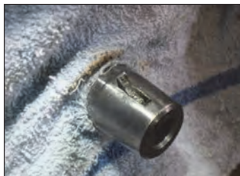
شکل ۸۱-نمونه ای از معایب مربوط به خارها
