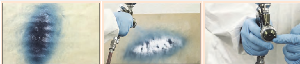
شکل ۶۶- تنظیم جهت پاشش
