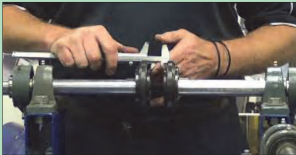
شکل ۷۶- کنترل هم راستایی کوپلینگ با استفاده از کولیس
