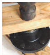
شکل ۷۰- جا زدن کاسه نمد
