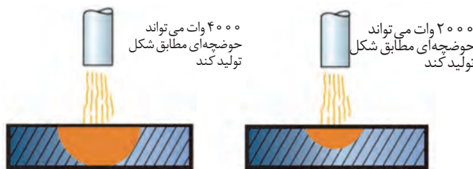
شکل ۳- وابستگی اندازه حوضچه جوش به مقدار انرژی (W)
