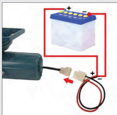
شکل ۴۲- اتصال پمپ با سوکت به باتری
