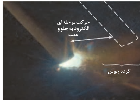
شکل ۴۲- در تکنیک‌های جوشکاری الکترود به آرامی به سمت جلو می‌رود و دوباره به حوضچه جوش بر می‌گردد
