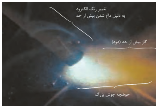
شکل ۲۷- جوشکاری با آمپر بسیار بالا
