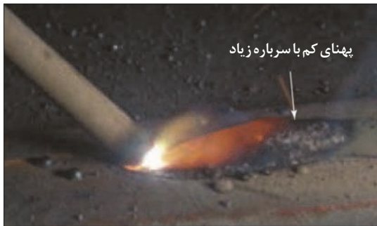
شکل ۳۰- جوشکاری با طول قوس بسیار کم
