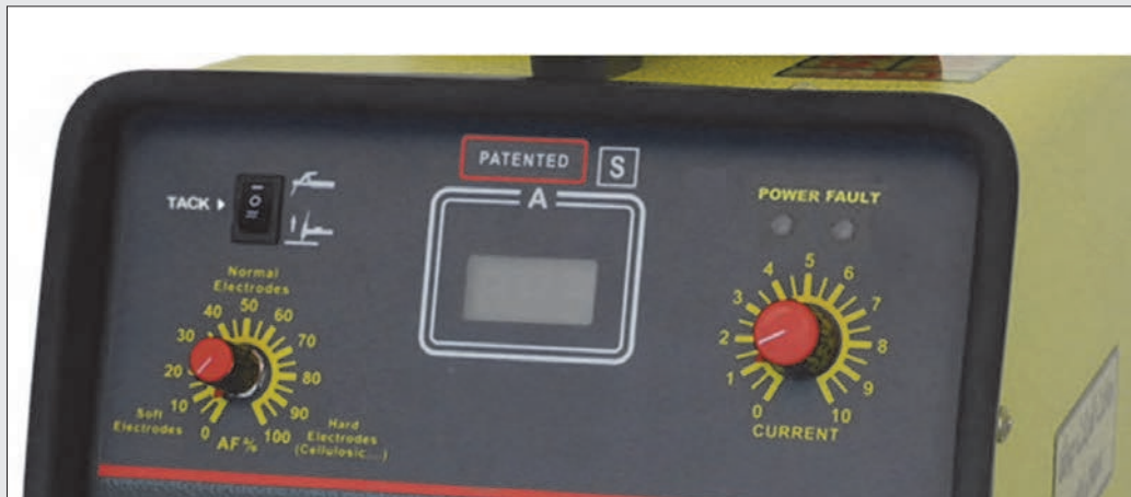
شکل ۲۲- روی صفحه کلید دستگاه‌های جوشکاری، کلیدهای متعددی وجود دارد که جوشکار باید به عملکرد آنها مسلط باشد
