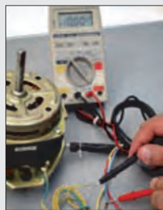
شکل ۷- آزمایش اتصال بدنه
