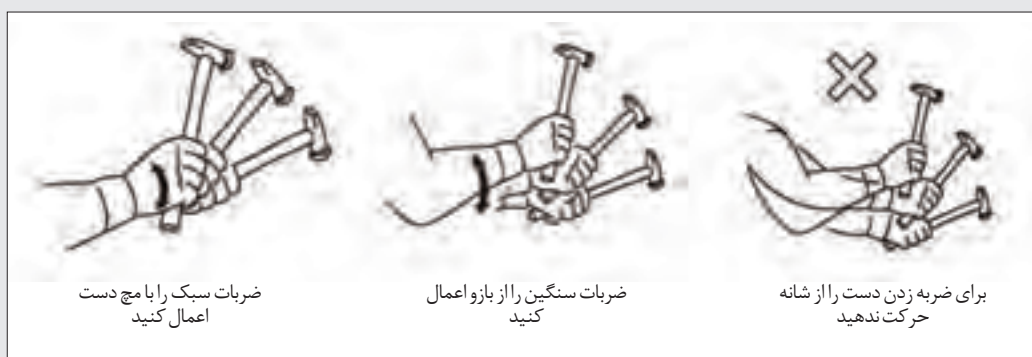
شکل ۵۰- روش ضربه زدن با چکش
