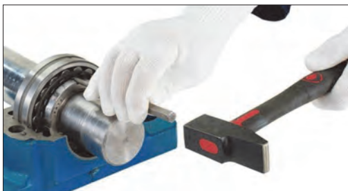
شکل ۶۲- جدا کردن بیرینگ از بوش از بوش مخروطی
