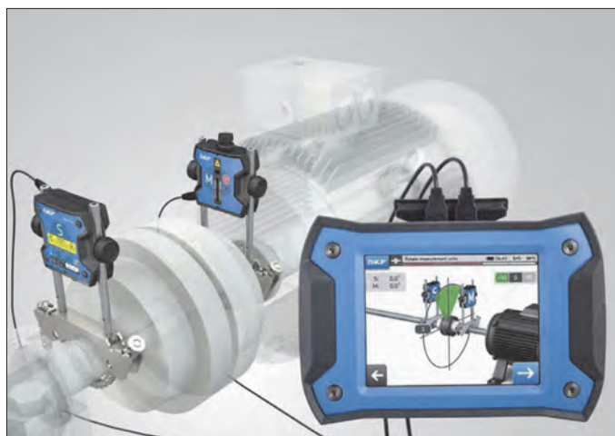
شکل ۷۸- هم‌راستا کردن محورها با دستگاه لیزر
