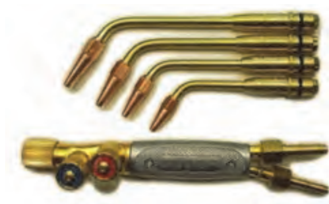
شکل ۶- مشعل جوشکاری و سرمشعل‌های آن
