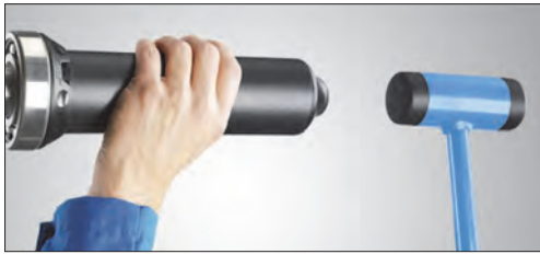
شکل ۵۸- جا زدن بلبرینگ با استفاده از ابزار مخصوص
