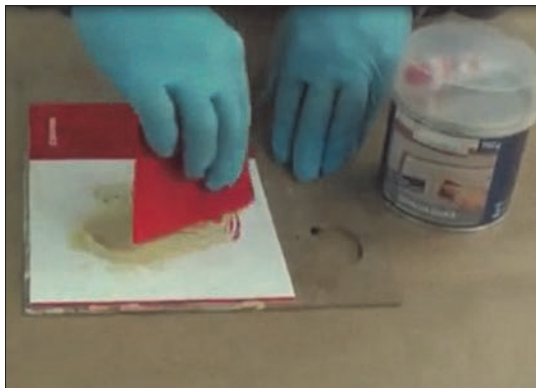
شکل ۵۵- دو جزء بتونه سنگی و مخلوط کردن آنها
