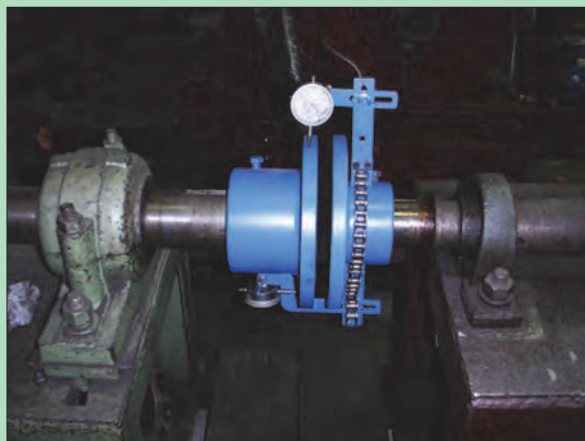
شکل ۷۷- هم‌راستا کردن محورها با ساعت اندازه‌گیری
