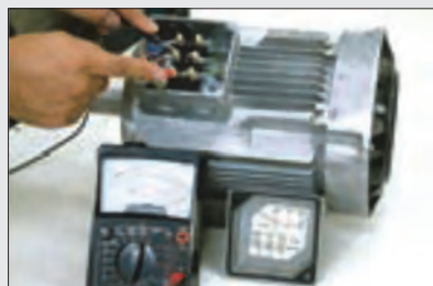
شکل ۶- آزمایش الکتروموتور با استفاده از مولتی متر
