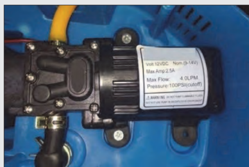
شکل ۳۲- اتصال پمپ و رعایت جهت حرکت سیال
