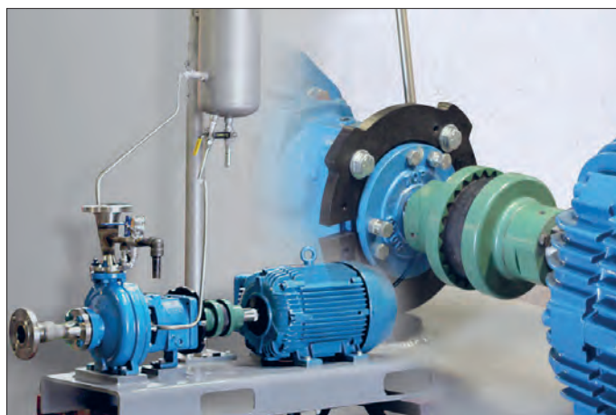
شکل ۸- انتقال قدرت مستقیم از موتور به دستگاه
