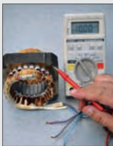
شکل ۷- آزمایش اتصال بدنه
