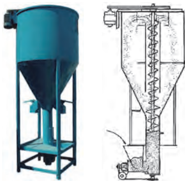
شکل ۷- مخلوط‌کن عمودی و نحوه عملکرد آن
